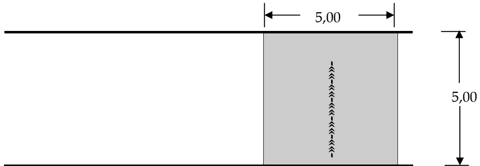
figura 3 scavo trasversale alla carreggiata
