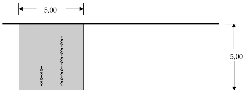
figura 4 doppio scavo trasversale alla carreggiata
